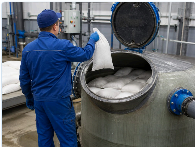
Загрузка АСВ Ультра в сорбционный фильтр ЛОС — вручную, без крана и спецтехники
