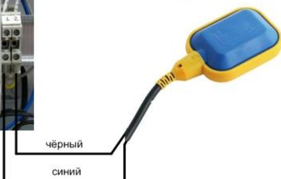
**Рис. 5 Подключение одного датчика уровня к установке.**
