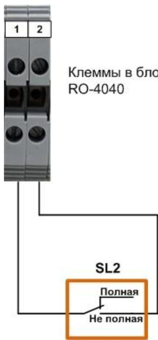
**SL2** - верхний поплавковый датчик уровня
