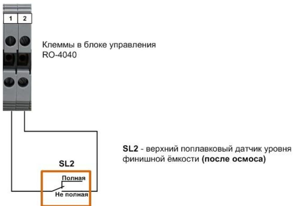
*Рис. 7 Электрическая схема подключения датчика уровня к установке.*
