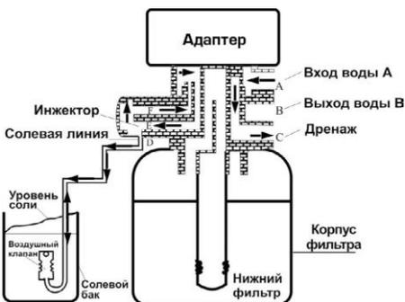
Необработанная вода входит в адаптер через вход **A**, через центральную часть адаптера к выходу инжектора **E** и через соединительный элемент солевого бака **D** попадает в солевой бак. Другая часть воды проходит через выход инжектора **E** и через небольшое отверстие к входу инжектора **F**, затем через корпус адаптера, центральную часть адаптера и выходит через слив **C**.
