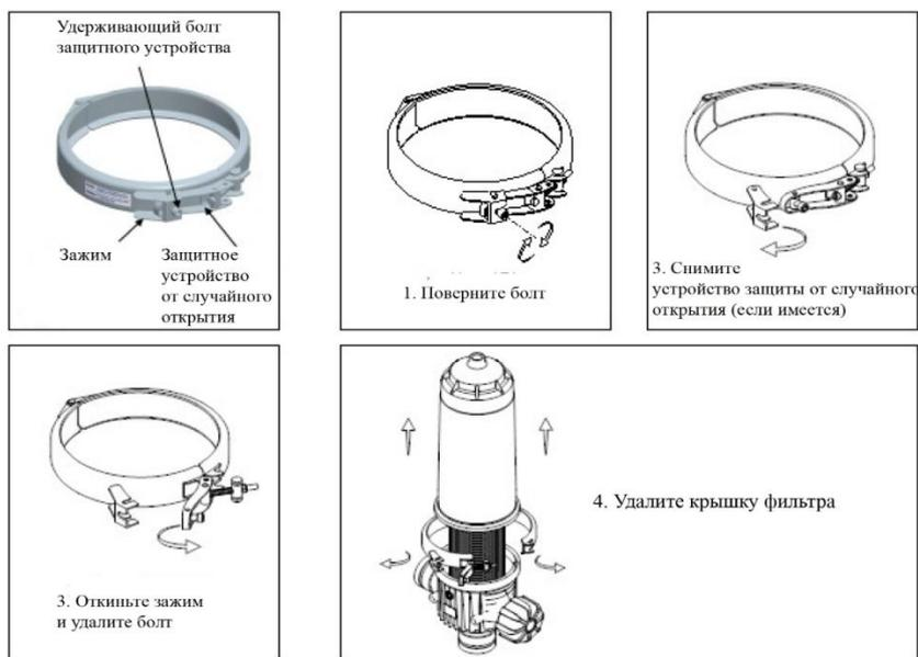
Перед ЗАКРЫТИЕМ фильтра убедитесь, что в зоне крепления нет инородных предметов, также проверьте состояние прокладки. Аккуратно установите на место крышку и закрепите фильтр с помощью зажима. Для закрытия зажима установите болт на место и закрепите защелку, установите устройство защиты от случайного открытия и без усилия заверните защитный болт.
