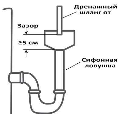
Наиболее оптимальным является установка фильтра выше уровня линии дренажа и на расстоянии не более 6,1 м от него. Используя подходящие шланг к дренажному выходу на управляющем механизме. Диаметр и длину минимальное гидравлическое сопротивление при обратной промывке.
