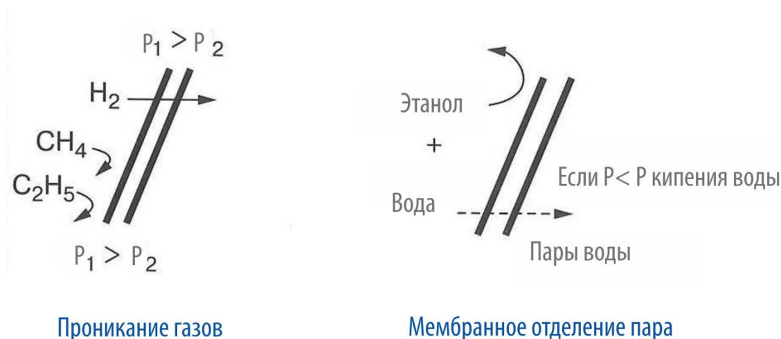
Рис. 5 Технологические процессы на основе проникновения через мембрану
