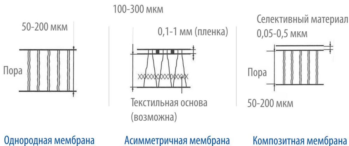
Рис.2 Принципиальная схема структуры однородных, асимметричных и композитных мембран
