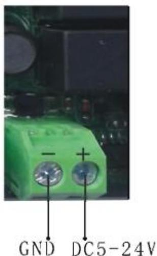
**Рисунок 3-9 Подключение к разъёму удалённой обработки**
