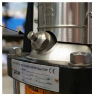
Рис. 6 Пробка на насосе для выпуска воздуха.
