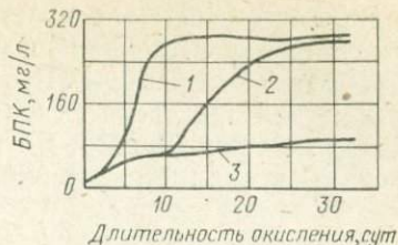
Рис. 16. Зависимость BPK воды, очищенной на биофилтре, при добавке аллилтиомочевины
