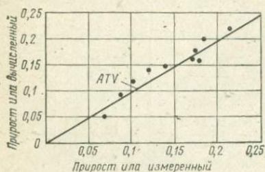
Рис. 27. Сравнительная оценка рекомендаций ATV к расчету прироста ила на основании среднегодовых отчетных данных эксплуатации 10 станций Большого Лондона за 1970—1972 гг.
