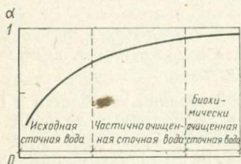
Рис. 25. Влияние степени биологической стабилизации воды на коэффициент массопередачи кислорода \alpha
