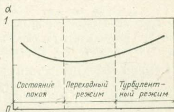
Рис. 26. Влияние степени перемешивания на коэффициент массопередачи кислорода \alpha
