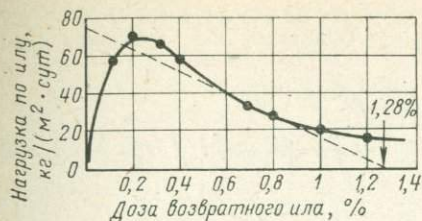
Рис. 34. Зависимость степени уплотнения возвратного ила от нагрузки по илу на вторичные отстойники
