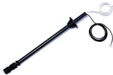
Всасывающие устройства из ПВХ / ПП с обратным клапаном для обеспечения точной работы дозирующего насоса. Всасывающие устройства оснащены донным фильтром. Доступны версии из FPM и EPDM.
