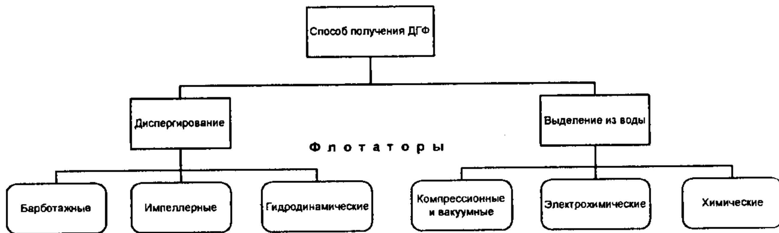
Рис. 13.1. Классификация флотационных сооружений по способу получения ДГФ
