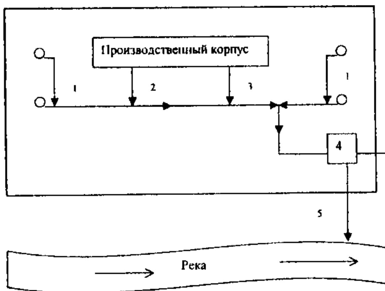
Рис. 4.1. Схема общесплавной системы водоотведения промышленного предприятия:
