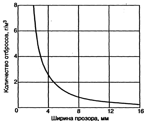
Рис. 11.1. Зависимость массы задержанных отбросов от ширины прозоров решетки
