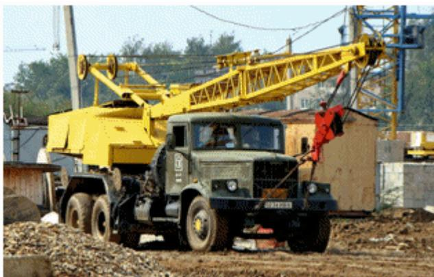
Рис.4. Автомобильный кран КС-4561А
