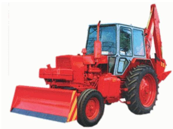
Рис.2. Одноковшовый экскаватор ЭО-2621В
