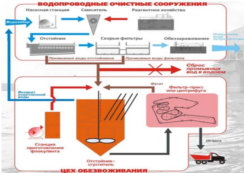
Рис. 1. Технологическая цепочка водоподготовки с обезвоживанием осадка
