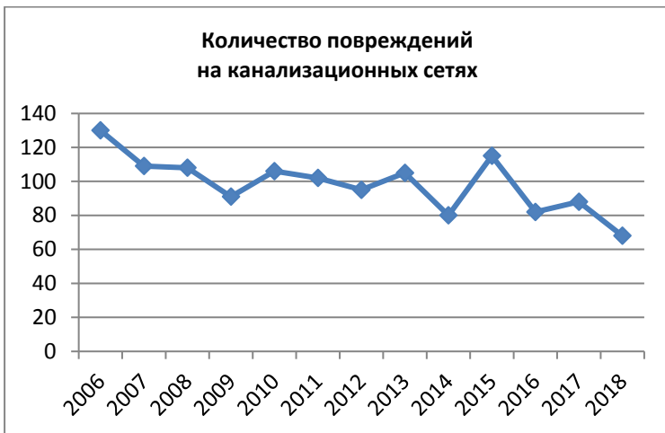
Рис. 4. График повреждений на канализационных сетях
