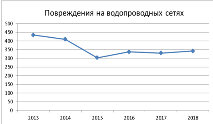
Рис. 1. Количество повреждений на водопроводных сетях за 2013–2018 гг.
