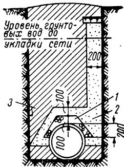
Рис. 61. Дренажно-дождевая труба в плохо фильтрующих грунтах
