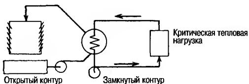
Рис. 38.5 В наиболее критических областях применения теплопередачи, вода в замкнутом контуре используется для химического контроля в целях предотвращения отказа оборудования; и охлаждение такой воды происходит в открытом контуре:
