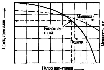
**Рис. 45.12** Типичная рабочая характеристика центробежного насоса с открытым рабочим колесом. Расчетная точка обеспечивает возможность регулирования потока в разумных пределах путем дросселирования давления на стороне нагнетания. Максимальная мощность требуется при иulleвом напоре нагнетания.
