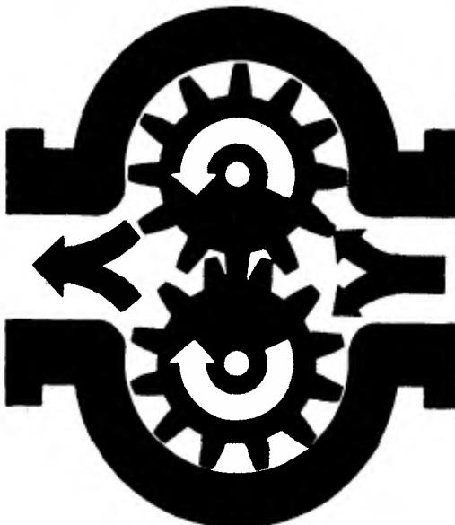
Рис. 45.6 В шестеренчатом насосе полости между зубьями зубчатых колес (шестерен) и корпусом перемещаются со стороны всасывания на сторону нагнетания и изолированы друг от друга за счет зацепления зубчатых колес. Одно зубчатое колесо является ведомым, а другое - промежуточным
