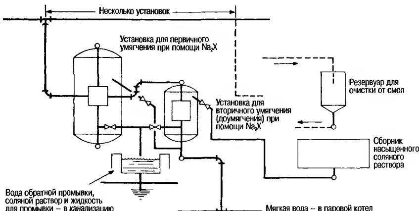
Рис. 43.15 Двухступенчатый процесс умягчения пластовой воды при помощи натриевого цеолита после очистки ее от нефти и фильтрации с целью последующего использования в котлах высокого давления.
