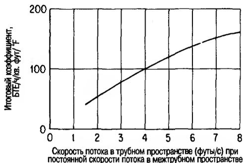
**Рис. 38.3** Изменение коэффициентов теплопередачи в зависимости от скорости, как в межтрубном, так и в трубном пространстве. Однородная скорость в межтрубном пространстве не может быть достигнута из-за ограничений в геометрии теплообменника.
