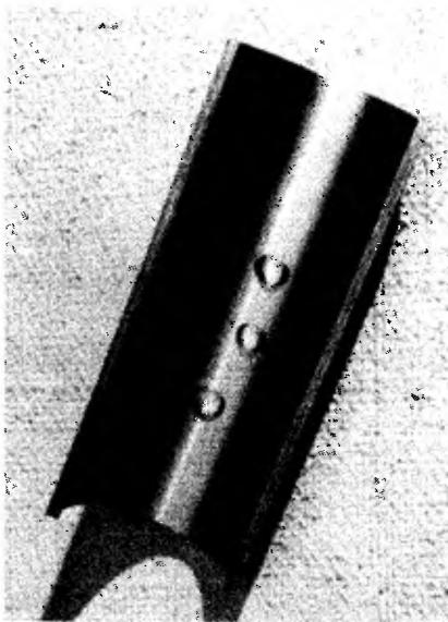
**Рис. 39.51** Пленкообразующие ингибиторы коррозии покрывают трубопровод конденсата несмачиваемой пленкой, защищая поверхность металла от коррозионного разрушения.
