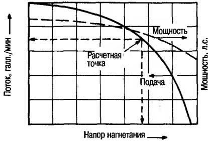
Рис. 45.12 Типичная рабочая характеристика центробежного насоса с открытым рабочим колесом. Расчетная точка обеспечивает возможность регулирования потока в разумных пределах путем дроселирования давления на стороне нагнетания. Максимальная мощность требуется при нулевом напоре нагнетания.
