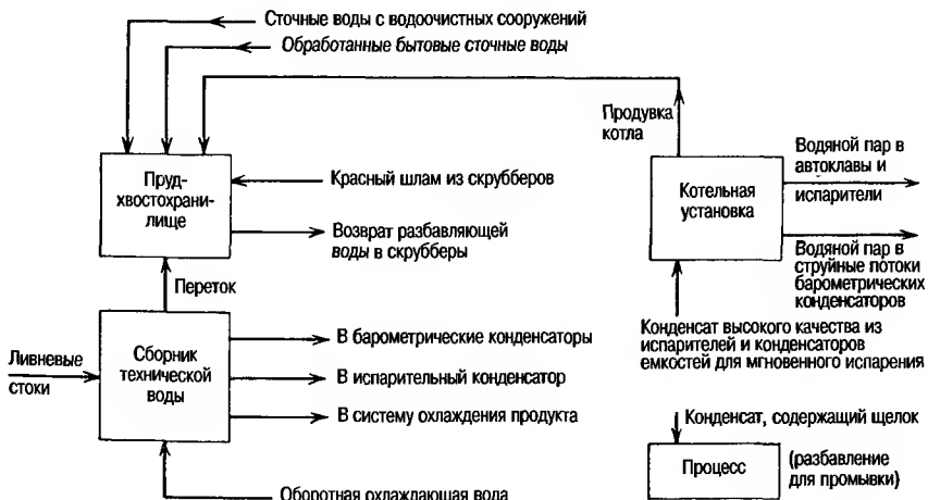
Рис. 24.2 Использование воды и водяного пара в процессе фирмы Вауег
