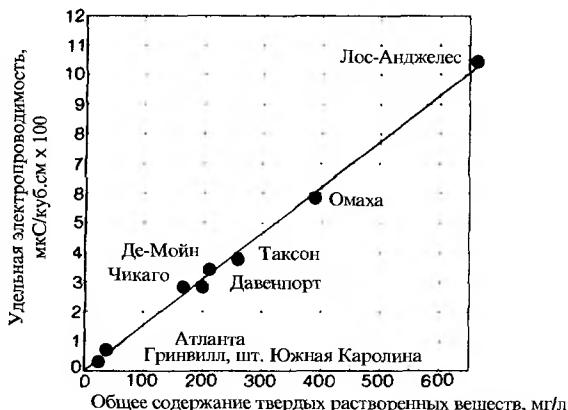
**Рис. 1.5.** Содержание растворенных твердых веществ в воде можно определить по ее удельной электропроводности. Для большей части коммунальных систем водоснабжения коэффициент пересчета равен 1,55 мкС (электропроводность на мг на литр общего содержания твердых растворенных веществ). В других случаях, например, если речь идет о сточных водах и котловых водах, коэффициент пересчета следует определять для каждого конкретного случая.
