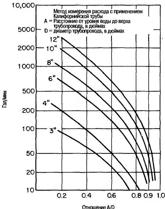
Рис. 7.20. График для определения расхода с применением Калифорнийской трубы
