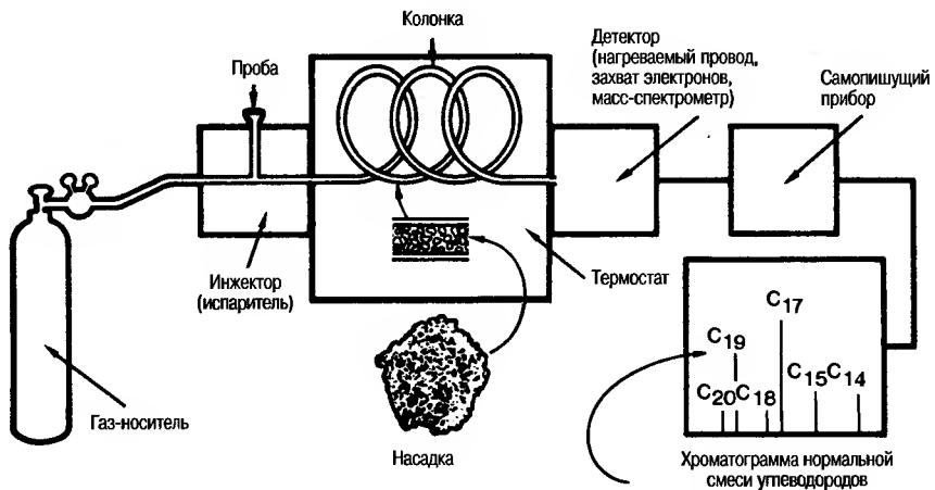
Рис. 7.44. Упрощенная схема газового хроматографа
