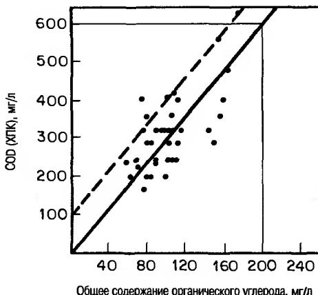
**Рис. 4.18** Зависимость между COD и TOC сточных вод химической установки (сплошная линия). Некоторые сточные воды характеризуются фоновой неуглеродистой COD, о чем свидетельствует пунктирная линия; для других сточных вод крутизна характеристики может быть иной.
