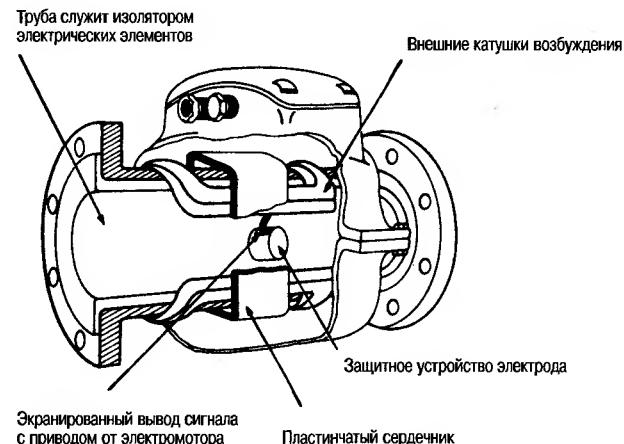
Рис. 7.9. Магнитный расходомер обеспечивает беспрепятственный поток, что облегчает проведение измерений расхода. (фотография предоставлена The Foxboro Company).
