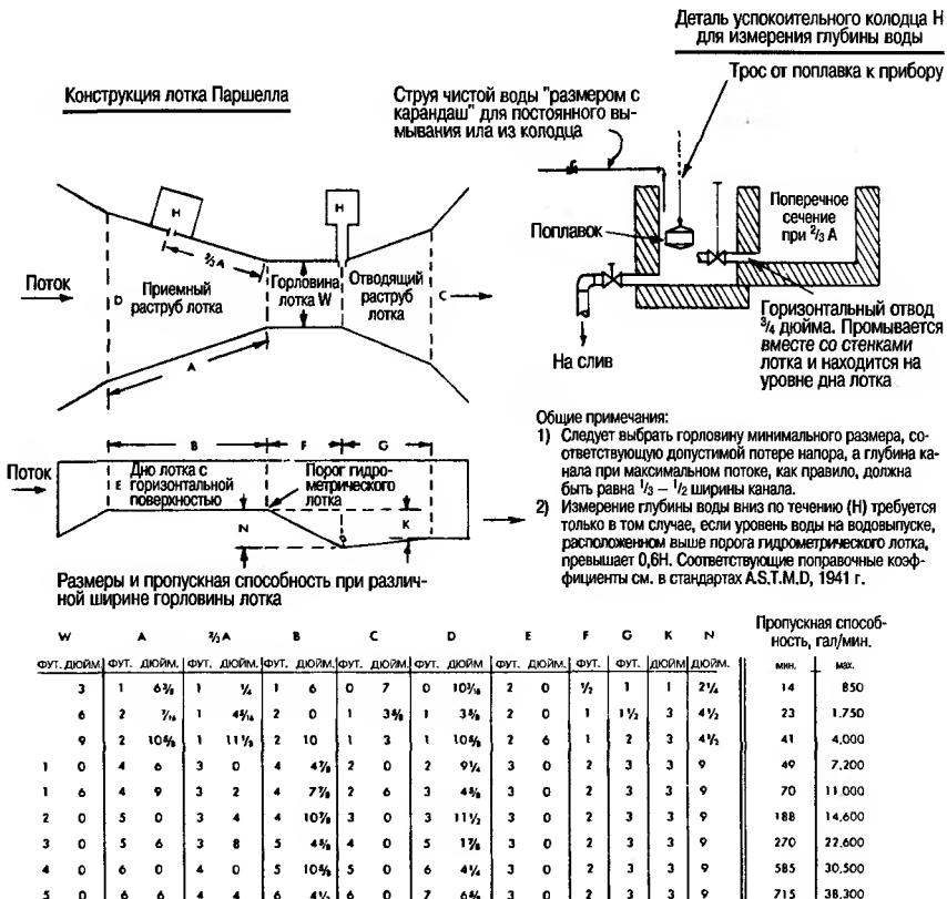
Рис. 7.13. Конструкция лотка Паршелла.
