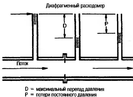
Рис. 7.5. Сравнение дифференциального напора и потерь постоянного напора при прохождении потока через диафрагму.
