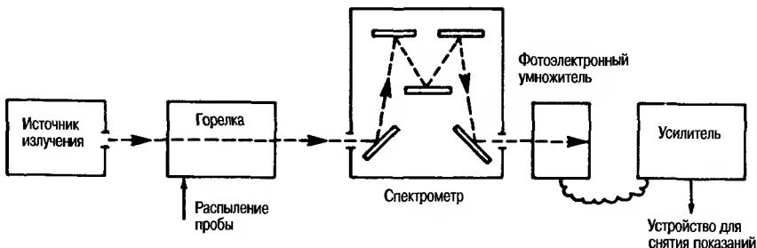
Рис. 7.30. Упрощенная схема абсорбционного спектрофотометра.
