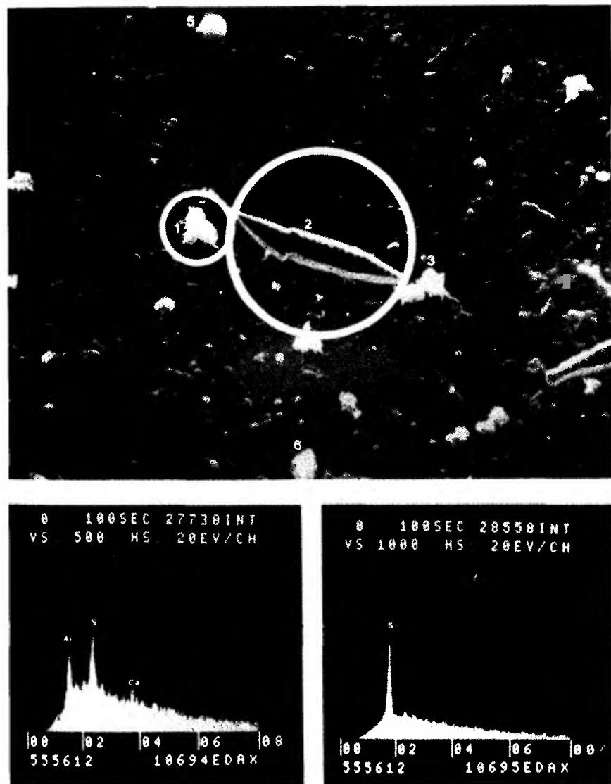
Рис. 7.37. Наблюдения микрочастиц в пробе сточной воды при помощи РЭМ с одновременным анализом отдельных частиц 1 и 2, представляющих собой осадок, содержащий кальций, серу и алюминий, а также диатомей.
