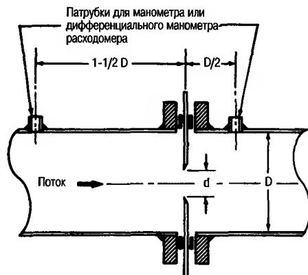
**Рис. 7.2.** Типичная схема установки диафрагмы для измерения скорости и объема потока
