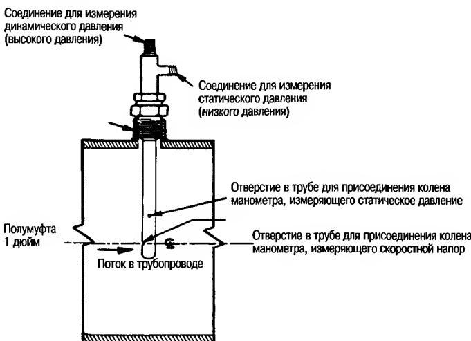
Рис. 7.8. Схема установки трубы Пито, на которой показаны соединения для измерения дифференциального напора (фотография предоставлена The Foxboro Company).
