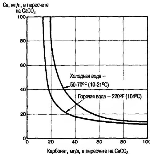
Рис. 4.7. Растворимость  $\text{CaCO}_3$  в системах с высокими и низкими температурами - эмпирические данные, полученные в условиях продолжительности реакций и осаждения 60-90 мин.
