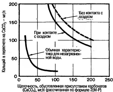
Рис. 4.8. Кривые, характеризующие процесс умягчения известью коммунально-бытовых сточных вод, имеющих низкую температуру (две кривые в верхней части графика), в сравнении с характеристикой процесса умягчения известью незагрязненной воды.
