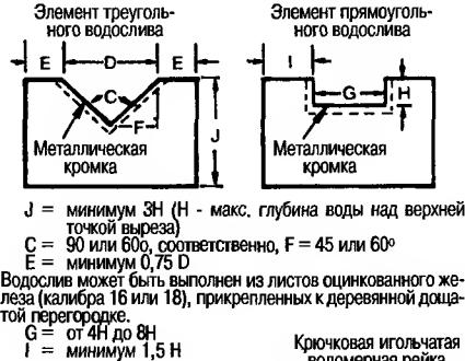
Водослив может быть выполнен из листов оцинкованного железа (калибра 16 или 18), прикрепленных к деревянной дощатой перегородке.
