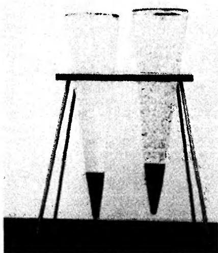
Рис. 4.14. Волюметрическое определение концентрации осаждаемых твердых веществ в конических классификаторах Имhoffа.
