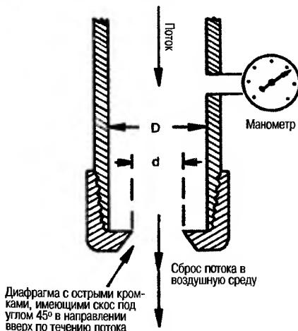
Рис. 7.17. Простой метод измерения расхода потока в канализационную систему или в открытый водоприемник при наличии в заглушке трубопровода открытой диафрагмы.
