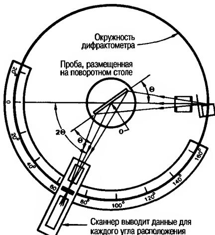
Рис. 7.34. Схема прибора, в котором используется дифракция рентгеновских лучей.
