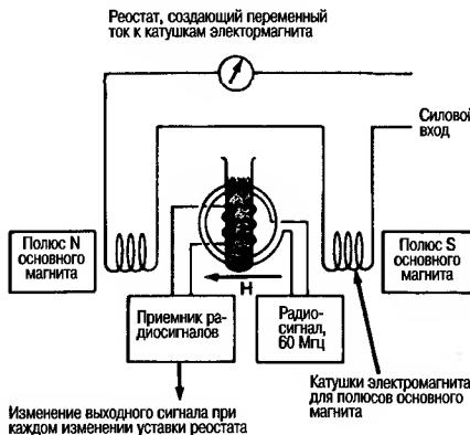
Рис. 7.42. Схема ЯМР-анализатора
