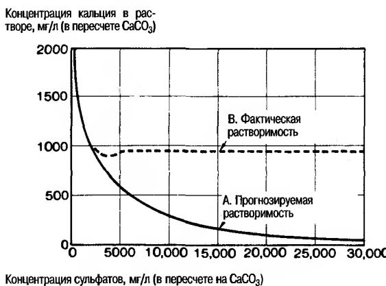
Рис. 4.12. Влияние ионной силы на растворимость  $\text{CaSO}_4$  в рециркуляционной охлаждающей воде
