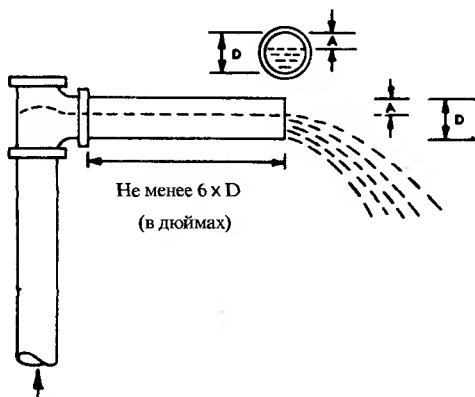
Рис. 7.19. Измерения, необходимые при применении метода с использованием Калифорнийской трубы
