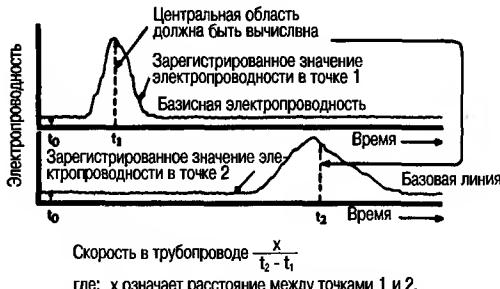
Рис. 7.22. Метод определения расхода путем измерения электропроводности требует точной дозировки вводимого химического вещества и измерения его концентрации. Этим методом можно определить расход в труднодоступных канализационных системах, для чего в каждом случае будет достаточно провести лишь одно измерение.
