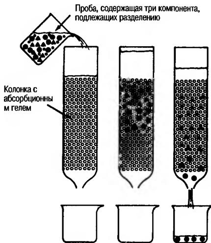
Рис. 7.43. Схема, показывающая принцип действия жидкостного хроматографа.
