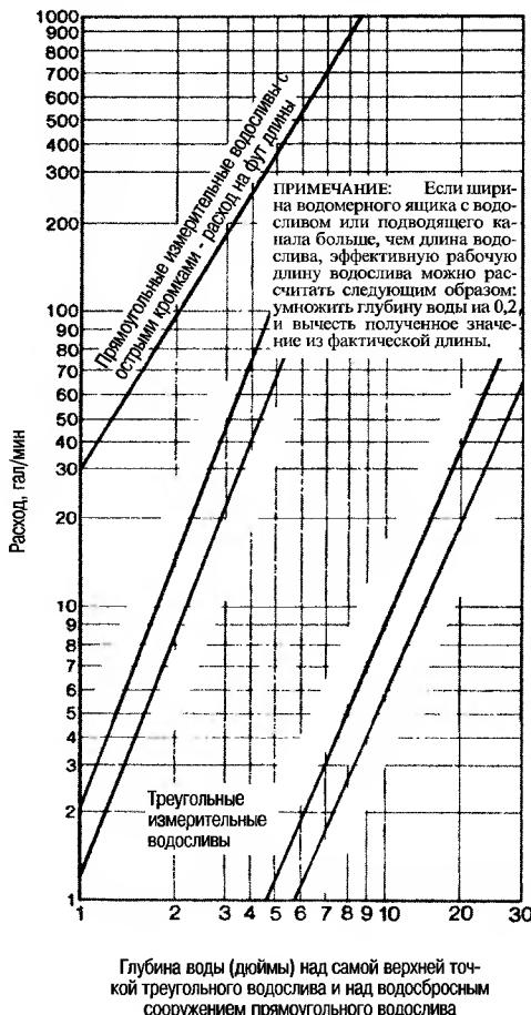
**Рис. 7.11.** Графики для определения расхода при помощи измерительного водослива, полученные на основе измерений уровня воды. График для прямоугольного водослива с тонкой стенкой может быть использован для определения расхода потока через плотину или через водосбросное сооружение осветителя с равномерным сбросом воды.
