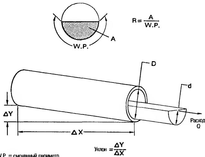
Рис. 7.21. Гравитационный поток в открытом трубопроводе.
