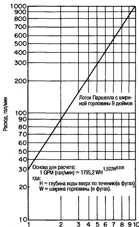
Глубина воды (в дюймах), измеренная в приемном растробе лотка на расстоянии, равном 2/3 длины приемного растроба вверх по течению от горловины
