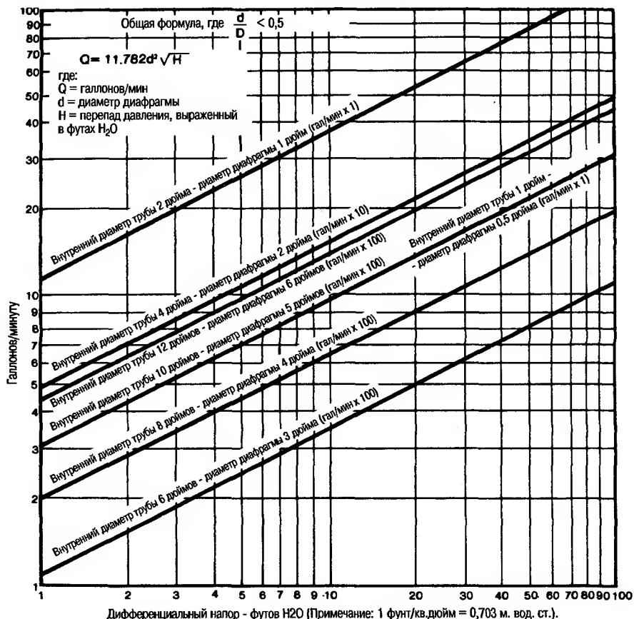
Рис. 7.3. Определение расхода потока через плоскую диафрагму на основе перепада давления\*
