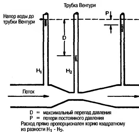
Рис. 7.6. Дифференциальный напор и потери постоянного давления при прохождении потока через трубку Вентури.
