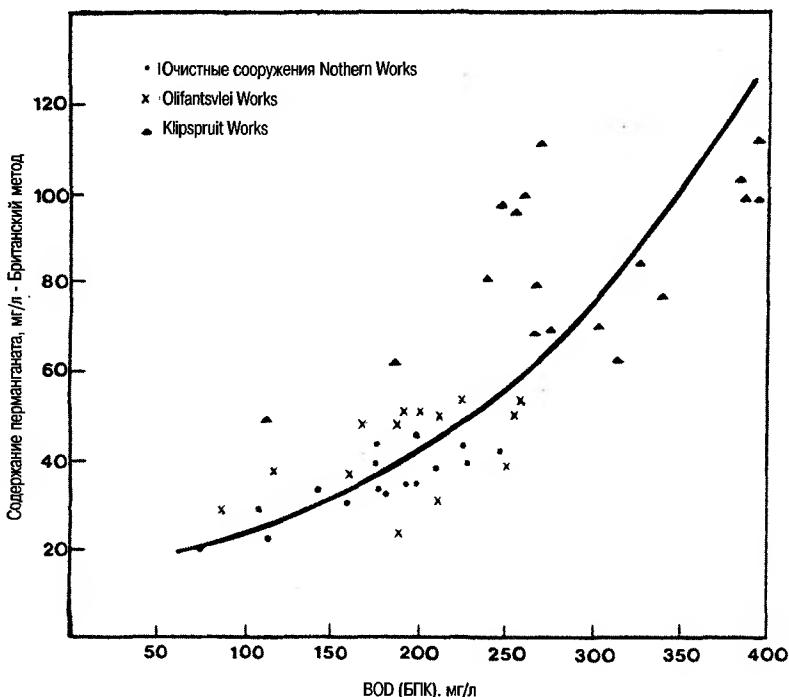
Рис. 4.19. Зависимость между потреблением кислорода (представленным как расход перманганата) и BOD (БПК), полученная при анализе сточных вод из первичного отстойника на станции водоочистки. Использовали специальный раствор перманганата. [из работы Osborn D.W. "Evolution of Wastewater Purification Process in Johannesburg, South Africa", *J. Water Pollut. Control Fed.*, 51: 3(472) (March 1979). Copyright Water Pollution Control Federation, reprinted with permission].
