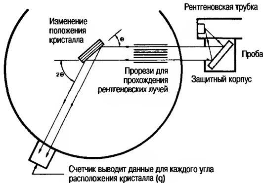
Рис. 7.33. Флуоресценция пробы под действием рентгеновских лучей.
