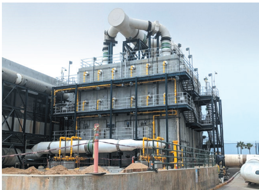
Рис. 3. Орошаемые биофильтры ОСК Лос-Анджелес, США
