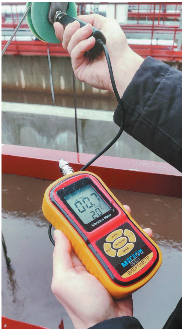
ИЗМЕРЕНИЕ УРОВНЯ ВИБРАЦИИ НА ПОДЪЕМНЫХ МЕХАНИЗМАХ СПУСТЯ 2 НЕДЕЛИ РАБОТЫ
