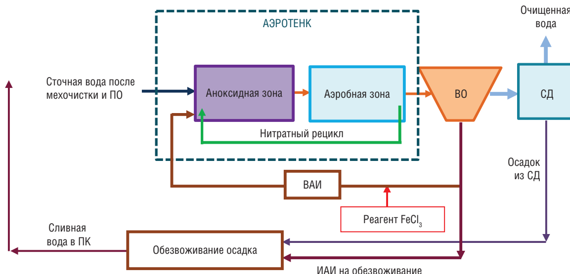
Рис. 2. Схема с предвключенной денитрификацией и химическим удалением фосфора: ВО – вторичный отстойник; СД – сооружения доочистки (фильтрования). СД могут использоваться в схеме при соответствующем обосновании их применения расчетами всего блока биологической очистки
