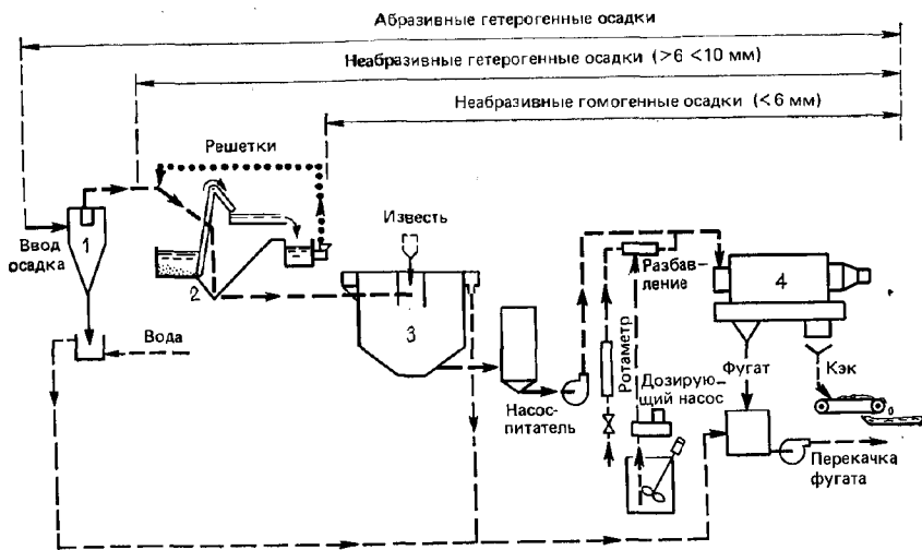
Рис. 17.34. Схема работы промышленной установки по обезвоживанию осадка на центрифугах
