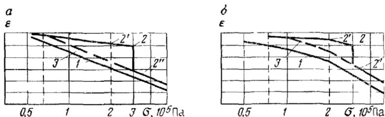
Рис 50. Логарифмические графики определения  $\delta_{пр}$  методом двух кривых по результатам испытания одного образца.
