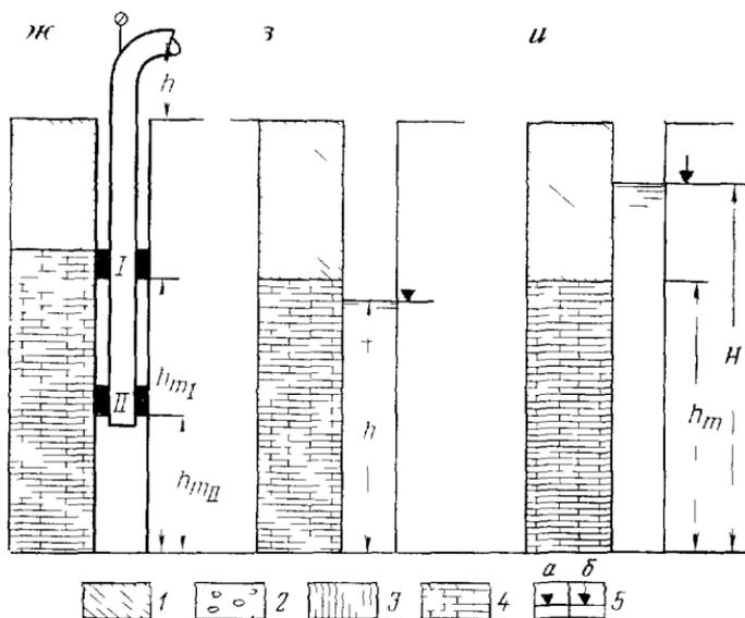
Рис 17 Расчетные схемы опытных нагнетаний и наливов воды в скважины
