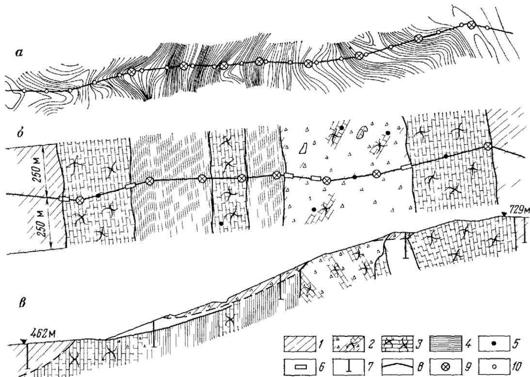
Рис 5 Трасса нефтепровода Бакв—Батуми на участке перехода через Ленгебизский перевал
