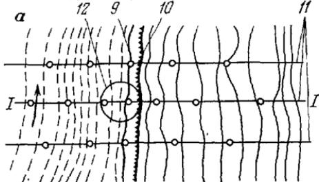
Рис. 7. Расположение разведочных скважин на участке укрепления берега реки.
