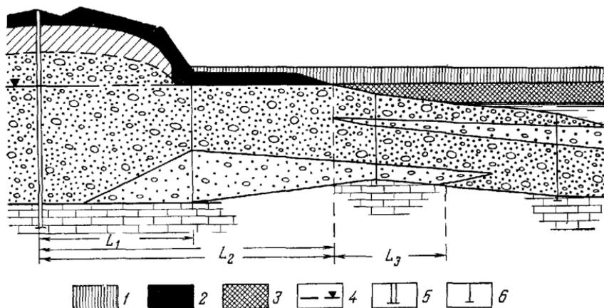
Рис. 31. Фрагмент поперечного геолого-литологического разреза высокой поймы и русла р. Китой на участке изысканий для инфильтрационных водозаборов.
