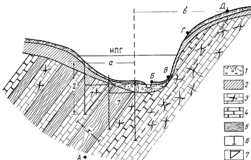
Рис. 13 Схема к определению шага между разведочными скважинами на створе плотности при наклонном залегании коренных разнородных пород.
