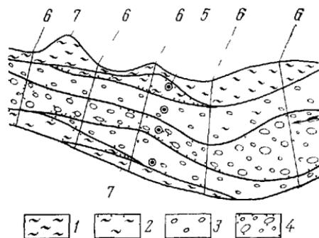
Рис 27 Фрагмент литологической карты дна русла р Ик на участке Ново-Тумугукского берегового (инфильтрационного) водозабора
