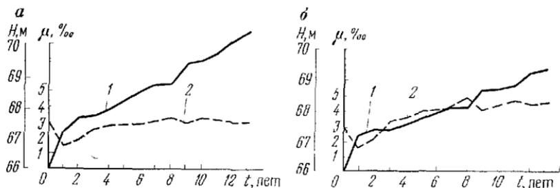
Рис. 36 Расчетные кривые изменения уровня и солености промышленных сточных вод НПЗ в пруде-накопителе-испарителе за расчетный период его эксплуатации.
