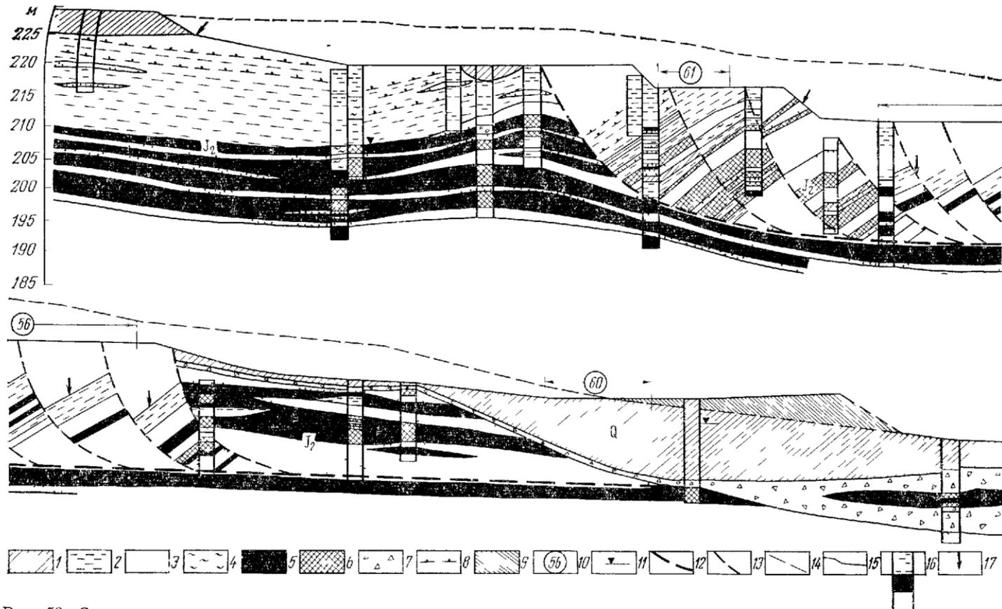
Рис 52 Схема древнего оползня
