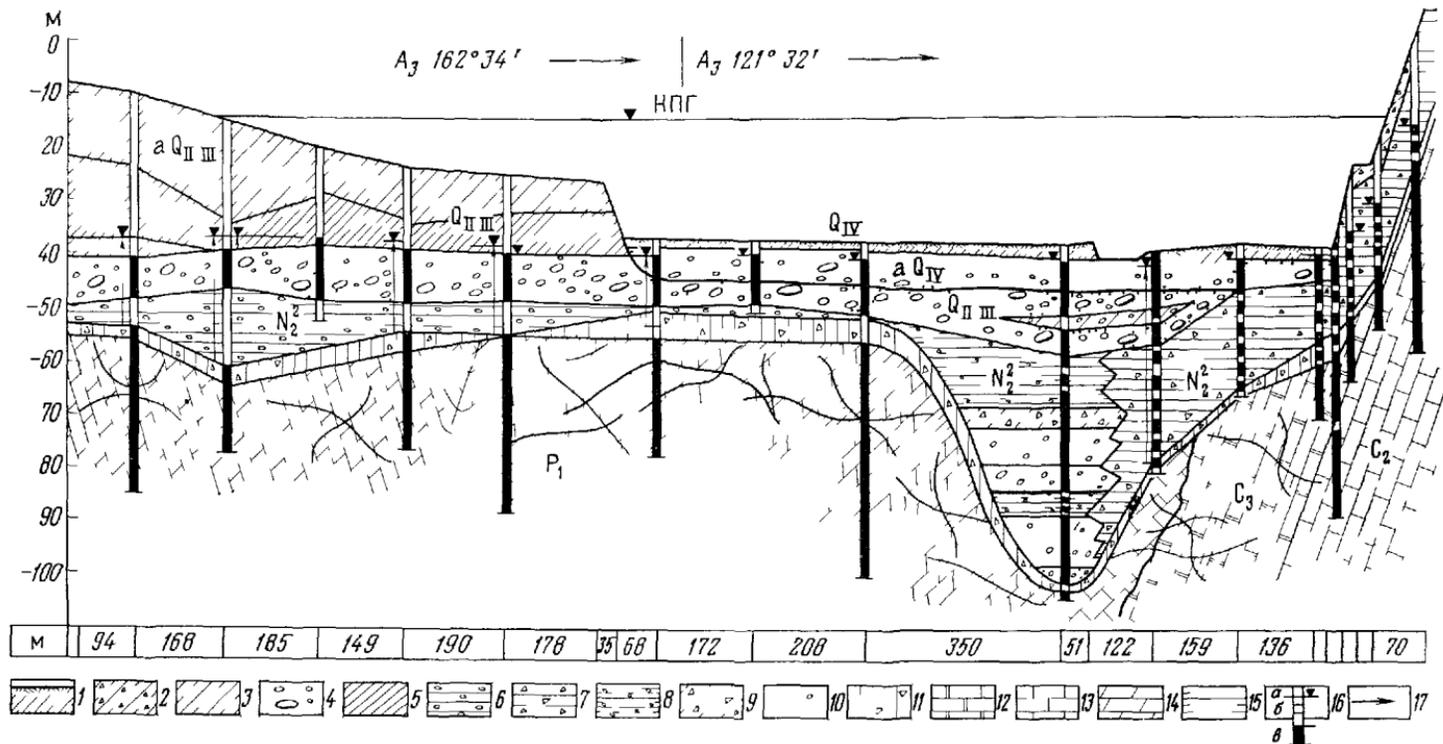
Рис 14 Геолого-литологический разрез по оси Нугушской плотины
