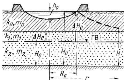
Рис 46. Схема к расчету фильтрации из накопителя; основание двухслойное, водоносный пласт неограниченный
