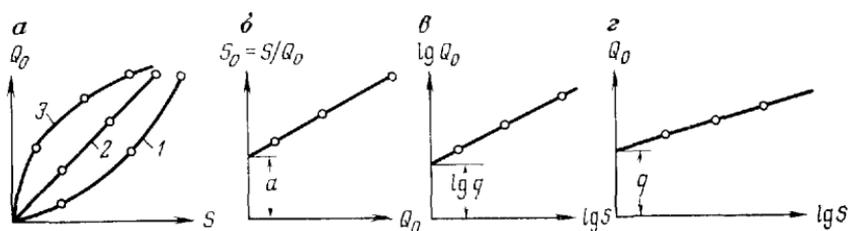
Рис. 18 Графики для определения удельного поглощения воды
