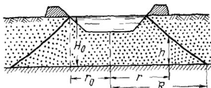
Рис. 49. Схема к расчету растекания проток из накопителя в «сухие» грунты
