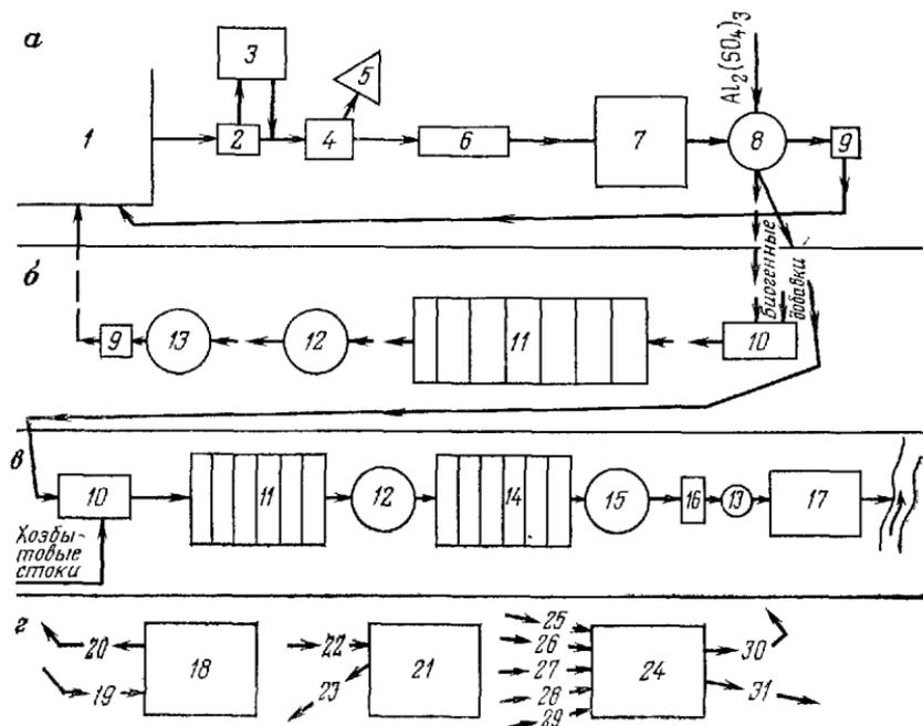
Рис. 32. Схема очистки и отведения производственных сточных вод нефтеперерабатывающих заводов.
