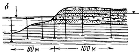
Рис. 6. Схема расположения разведочных скважин на участке проектируемого водозабора.
