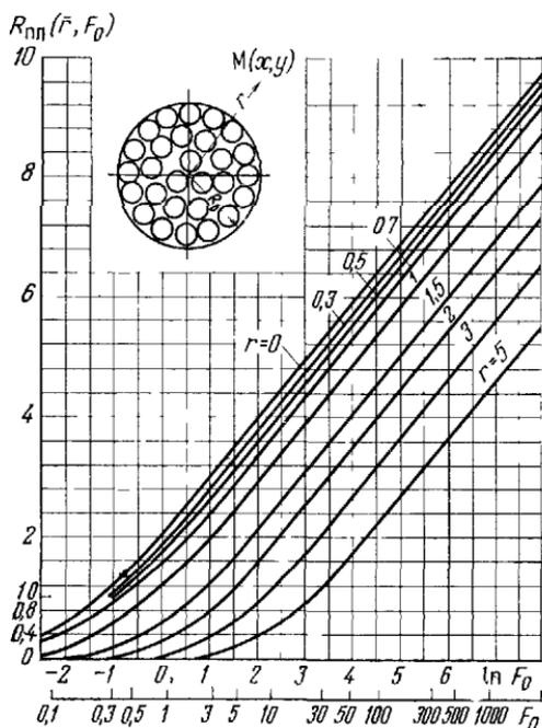
Рис. 47. График  $R_{\text{пл}} = f(\bar{r}, F_0)$  к формуле (98)
