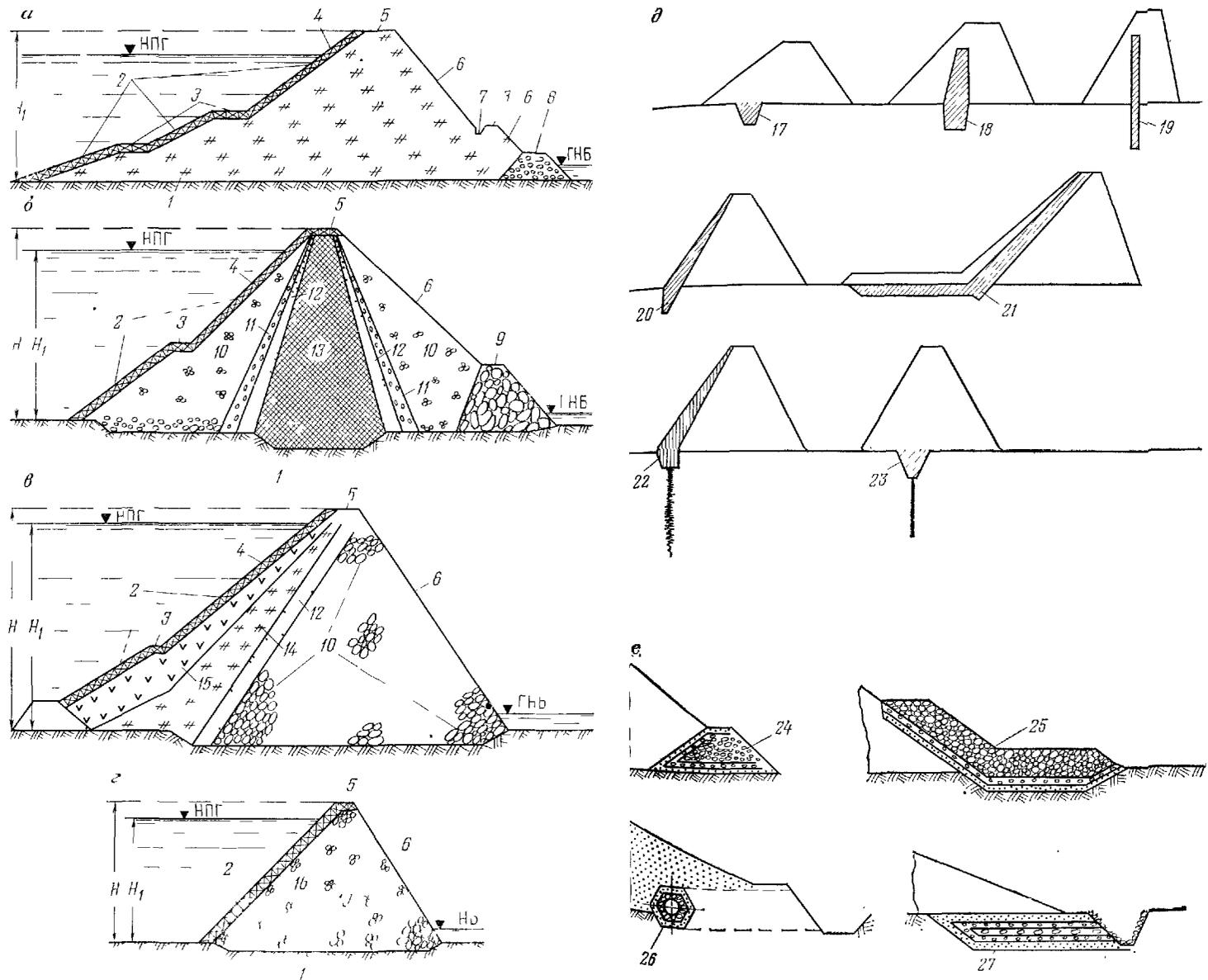
Рис 11 Типы водохранилищных плотин (а—г), элементы сопряжения тела плотины с основанием (д) и дренаж (е)
