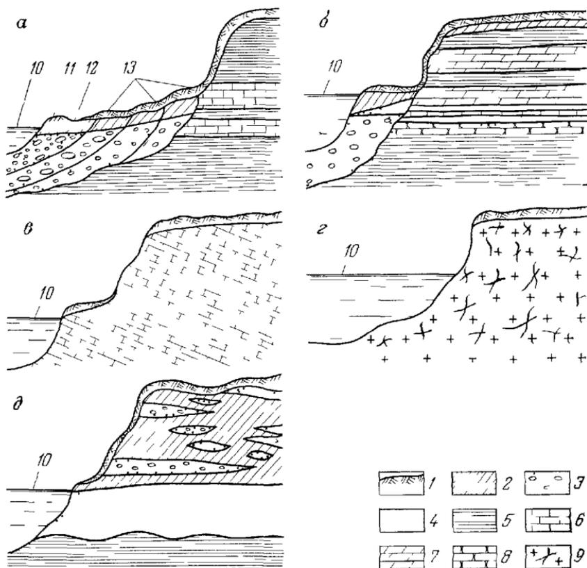
Рис 2 Схемы морфологического и геолого-литологического строения участков размещения открытых водозаборов в долинах рек
