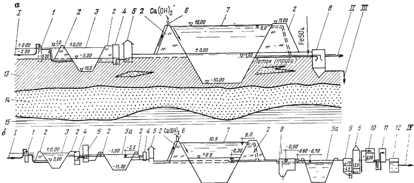
Рис. 34. Схема очистных сооружений промышленной канализации химического завода.
