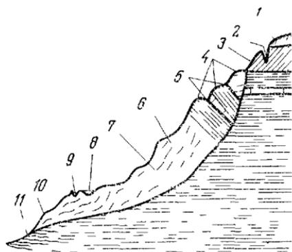
Рис. 51. Схема элементов оползня
