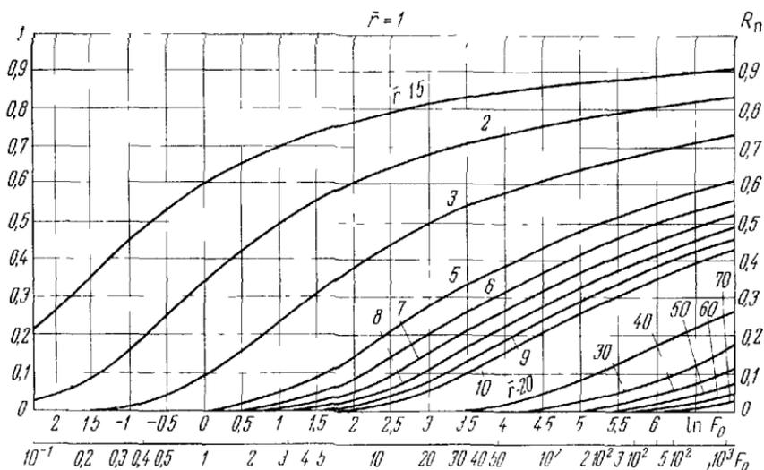
Рис. 44 График  $R_{\text{п}} = f(\bar{r}, F_0)$  к формуле (80)
