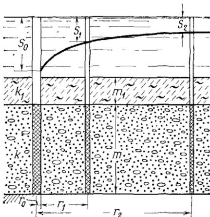
Рис. 29. Схема опытного налива для определения водопроницаемости донных отложений в русле р. Китой.
