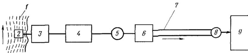
Рис 1 Схема сооружений водопровода из открытого источника
