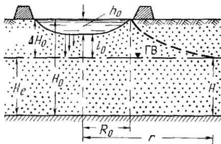
Рис. 43. Схема к расчету фильтрации промстоков из накопителя; основание однородное, водоносный пласт неограниченный
