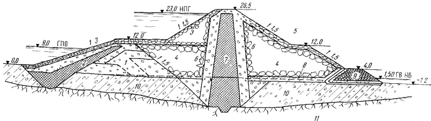
Рис 55 Профиль каменно-земляной плотины из грунтов полезных выемок
